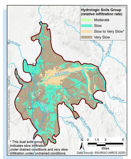
FIGURE 3: BIG VALLEY GROUNDWATER BASIN HYDROLOGIC SOILS GROUPS
